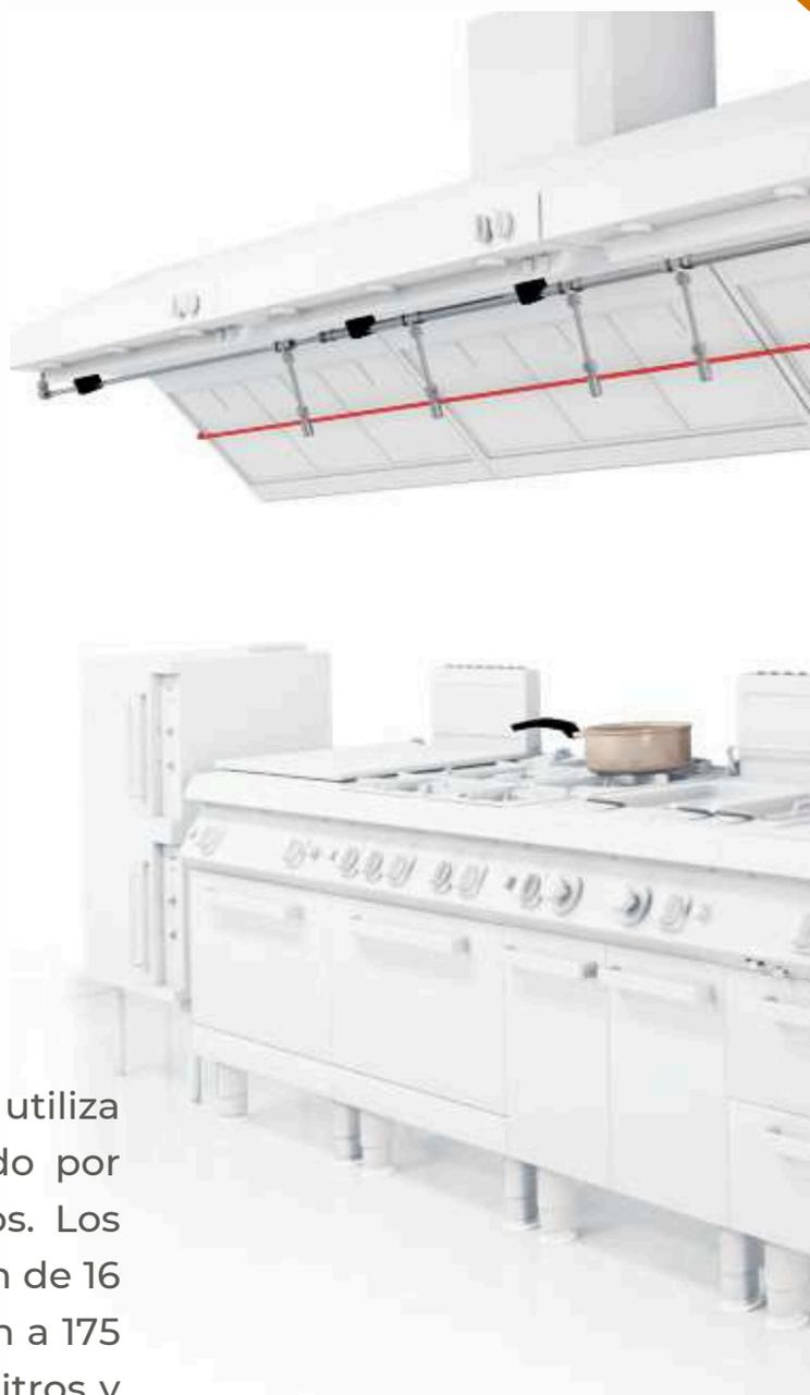
El sistema de extinción de incendios utiliza un agente extintor Clase F propulsado por nitrógeno, con un volumen de 9 litros. Los tubos y el cilindro operan a una presión de 16 bares, y los tubos de detección rompen a 175 °C. El cilindro tiene un volumen de 12 litros y pesa 13 kg cuando está lleno. El sistema funciona en un rango de temperatura de -20 °C a +60 °C.
